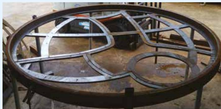
L'elemento strutturale del serramento è stato realizzato con un profilo normalizzato ad U, opportunamente rullato sul lato debole,
